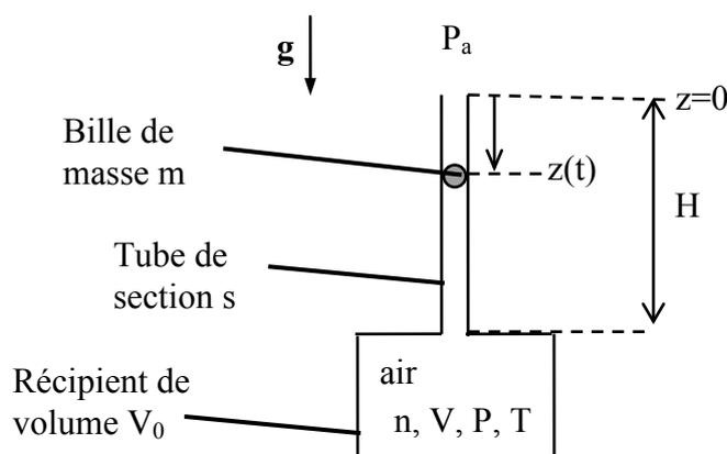
Figure 1 - Principe de l'expérience de Rüchardt.
