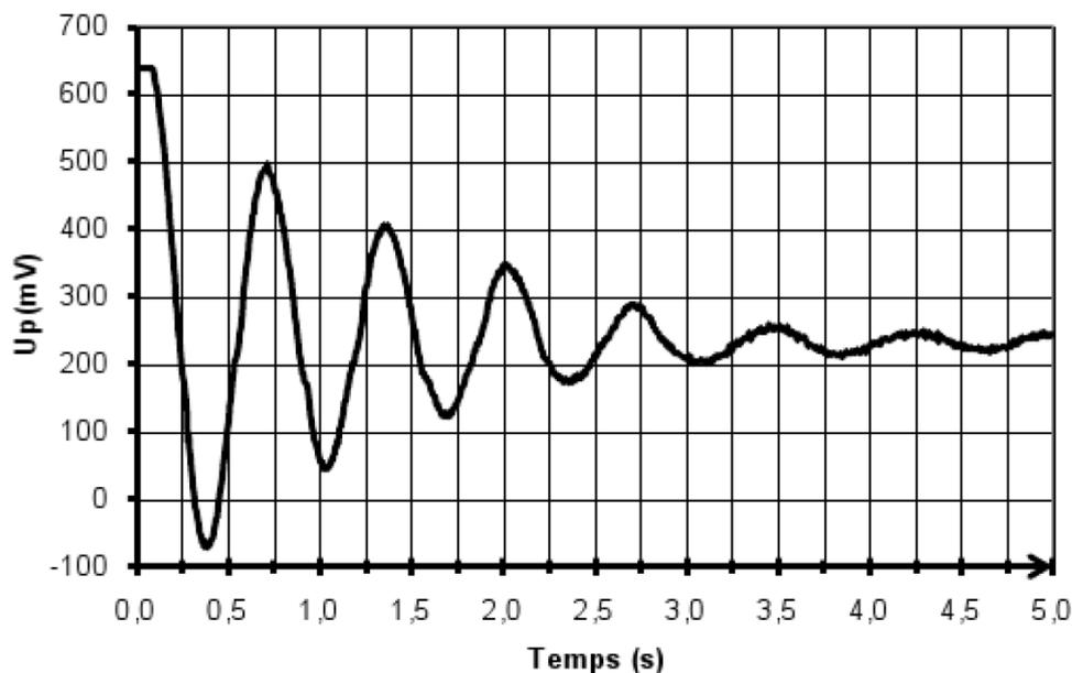
Figure 2 – Enregistrement des oscillations de la bille.
